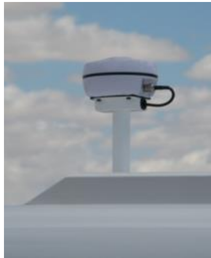
Ilustración 5. Antena externa del sistema de posicionamiento
